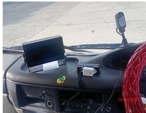
รูปที่ 3.1-1 (รูปที่ 46 ตัวอย่างระบบ GPS และระบบควบคุมความเร็วรถที่ติดบนรถขนส่ง)
